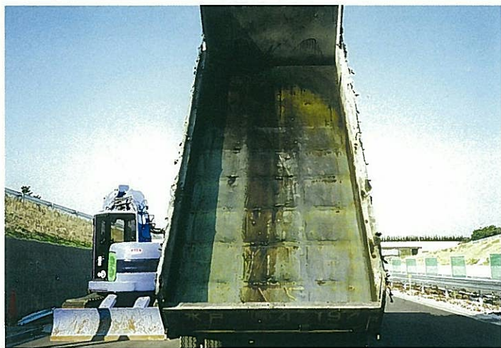
排水性舗装混合物運搬後のダンプカー荷台
